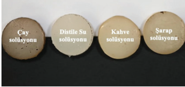
Şekil 1. Siyah ve beyaz arka plan üzerinde 28 gün renklendirilmiş örneklerin temsili görüntüleri
